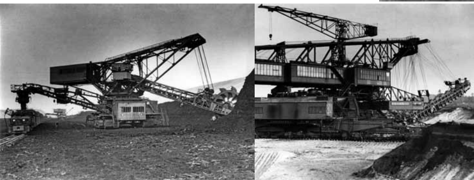
Eimerkettenbagger Es 1500-576 im Tagebau Niemtsch, um 1960
